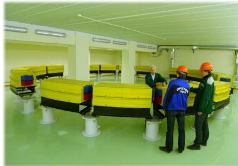
Сборка ускорителя ионов углерода на энергию 5,1 Гэв, г. Протвино, ЗАО «ПРОТОМ»
