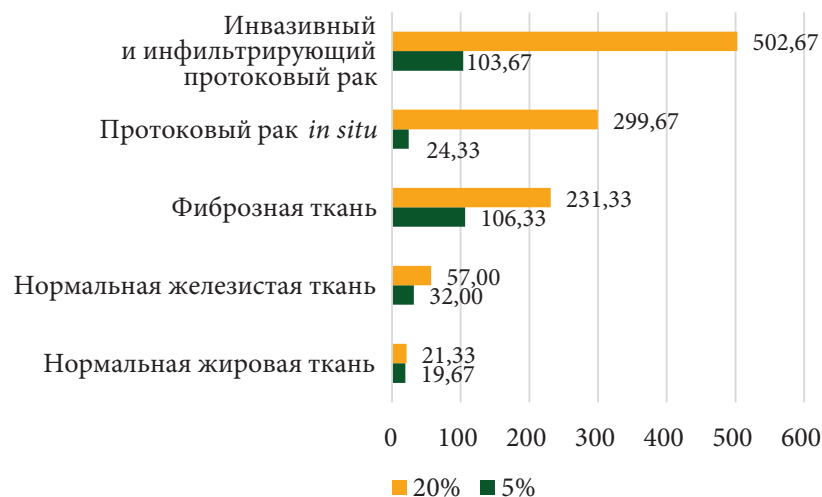
Рис. 1. Модуль Юнга тканей молочной железы (кПа), полученный при различных значениях скорости деформации (0,1; 1,0 и 4,0 Гц) и степени предварительной компрессии (5 и 20%) [10]
