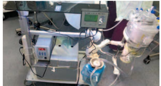
Рис. 1. Схема оригинальной перфузионной установки для выполнения изолированной регионарной перфузии конечности (1 – центробежный насос (ЦНИИ РТК, Санкт-Петербург), 2 – мембранный оксигенатор, выполняющий также роль резервуара, 3 – фильтр (Nipro Corporation, Япония), 4 – термостатирующее устройство (LOIP, Санкт-Петербург), 5 – рН-метр (ЦНИИ РТК, Санкт-Петербург))
