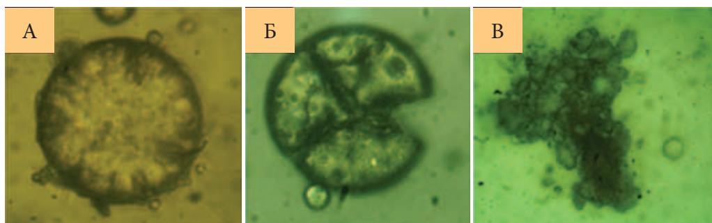
Рис. 5. Гидролитическая деградация микросфер с дексаметазоном в 0,025 М фосфатном буфере: А – 10 суток, Б – 30 суток, В – 90 суток (рН=7,4, температура 37 °С, средний размер микросфер 39,6 \pm 9,3 мкм, массовая доля включенного ЛВ 9,8 \pm 3,0\% )
