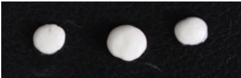
Рис. 4. Вид таблеток Эскейп после теста на распадаемость (одна из серий, среда исследования – вода, 15 минут)
