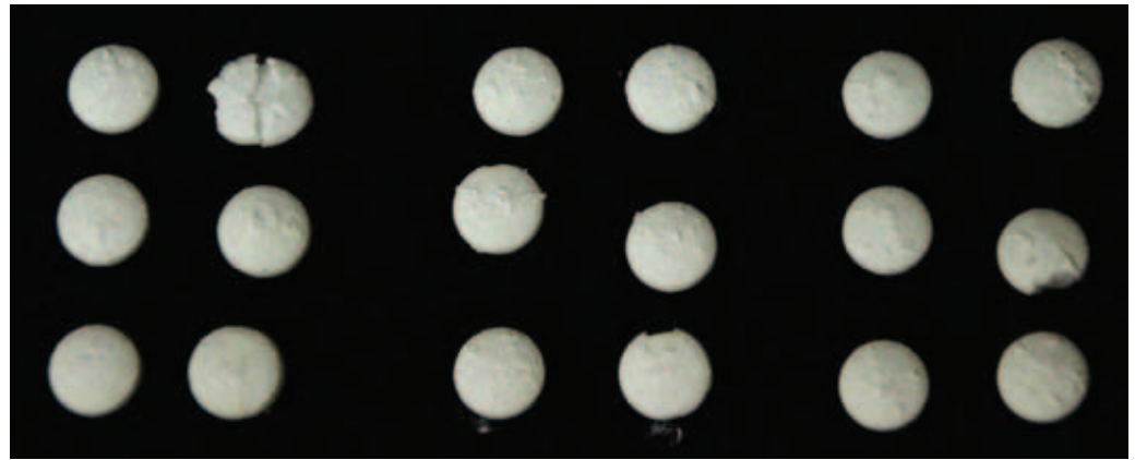
Рис. 5. Вид таблеток Новобисмол после теста на распадаемость (среда исследования – 0,1 М НСl, 30 минут)
