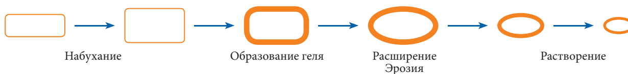
Рис. 1. Растворение таблетки монолитной матричной системы
