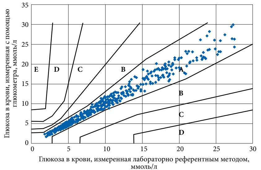
Рис. 1. Согласованная сетка ошибок показателей капиллярной крови при оценке точности глюкометра САТЕЛЛИТ® ONLINE
