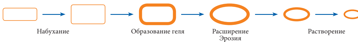
Рис. 1. Растворение таблетки монолитной матричной системы
